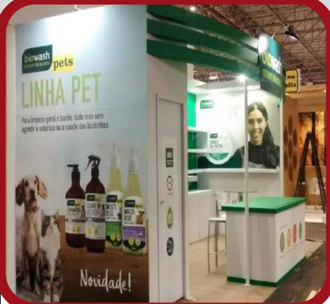
ADESIVAÇÃO DAS PAREDES INTERNAS E BALCÃO E REVESTIMENTO EXTERNO COM PLACAS DE PS ADESIVADAS
