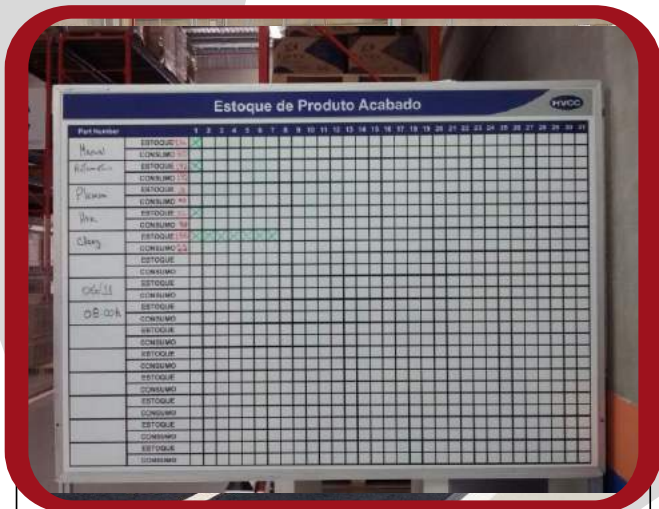
KANBAN EM ACM
