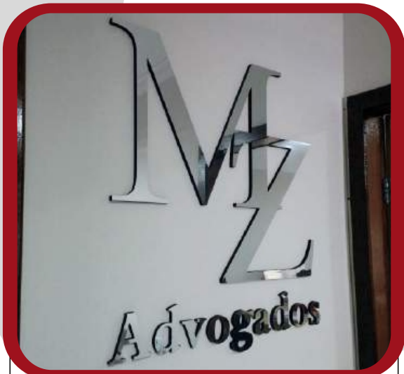
LETRAS EM PVC EXPANDIDO 10MM + ACM PRATA ESPELHADO
